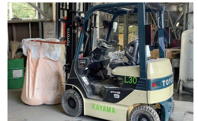
▶重機全体のうち、約30%にあたる11台をバッテリー式にして、再生可能エネルギーで稼働させています。
